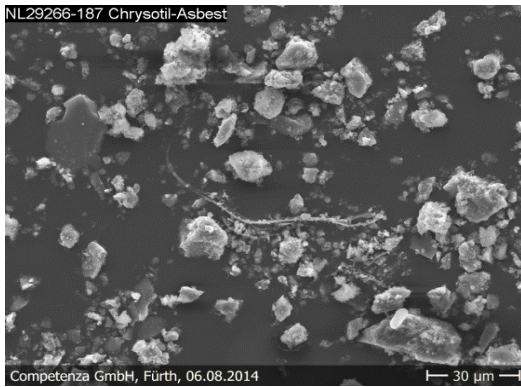
Abbildung und Elementspektrum: Chrysotil-Asbest Fundstelle NL29266.187
