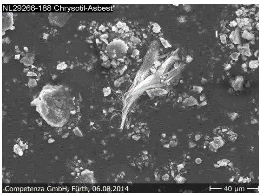
Abbildung und Elementspektrum: Chrysotil-Asbest Fundstelle NL29266.188
