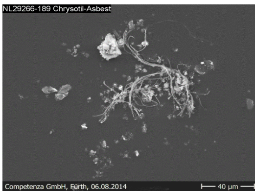
Abbildung und Elementspektrum: Chrysotil-Asbest Fundstelle NL29266.189
